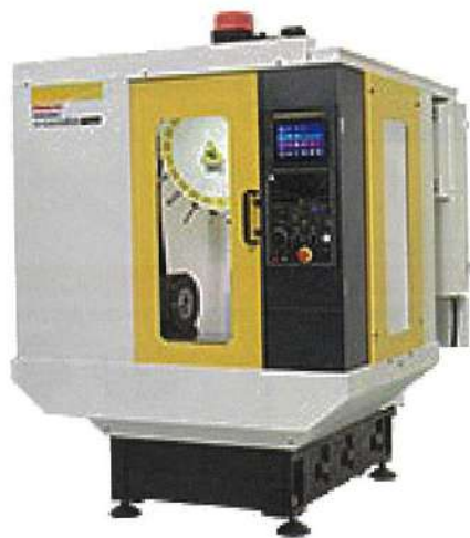
デモ機械: FANUCロボドリル α-D21MIB5 Plus
