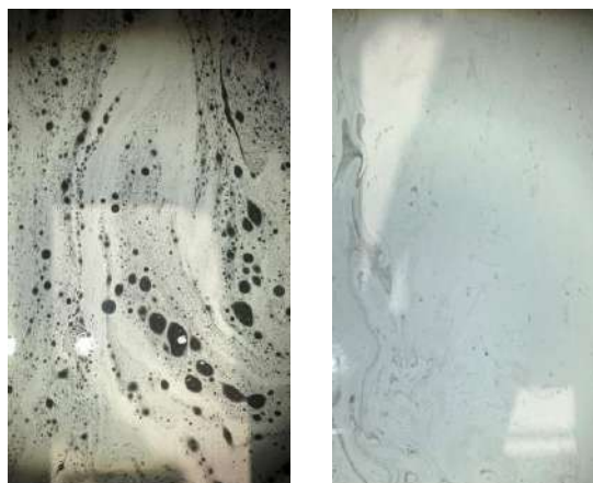
JCC-HM未使用機 JCC-HM使用機 クーラントタンク液面の様子
