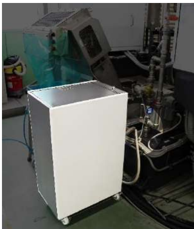
洗浄機のクリーンタンクに接続
