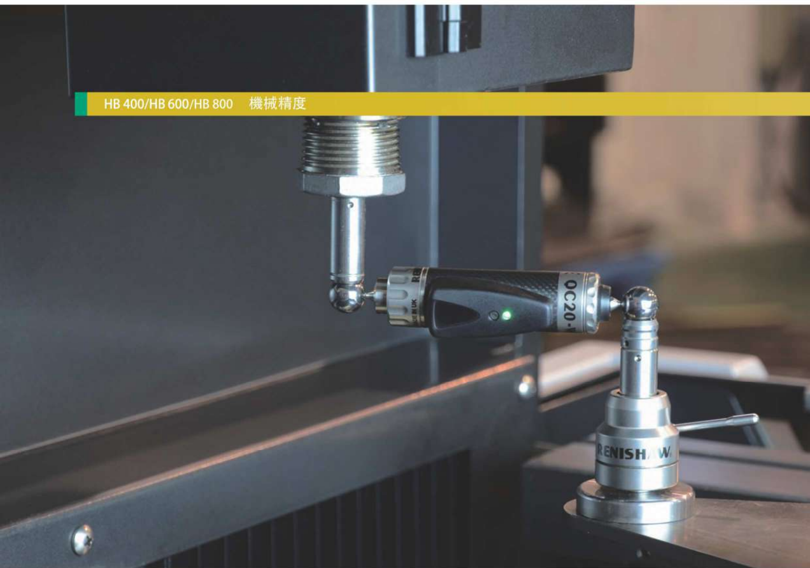
ボールバーを使用した円運動精度試験
