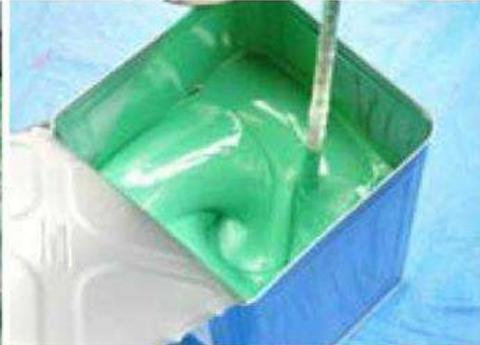
A液(主剤) B液(硬化剤)を指定の割合で約2分間攪拌機で混合してください。
