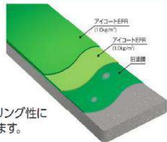
アイコートEFR(ローラー)は、一液タイプのアクリル系塗膜の上にそのまま塗布でき、レベリング性に優れているためローラー、刷毛等にて厚塗り可能なタイプの二液エポキシ樹脂塗料になります。
