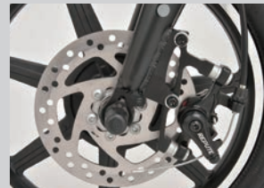
前後ディスクブレーキ採用 制動力に優れたディスクブレーキ を装備、安全に止まります。
