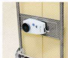
本体を横向きにして、台車の背板に取り付ける。
