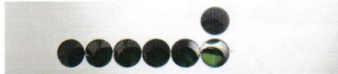
アルミ6063(二重板同時穿孔) φ6.0 S=3720rpm F=152mm/min
