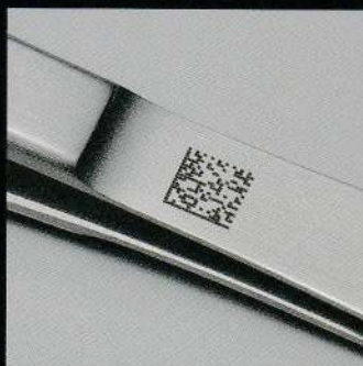
素材：ステンレス 対象物：医療ピンセット 印字例：データマトリックス
